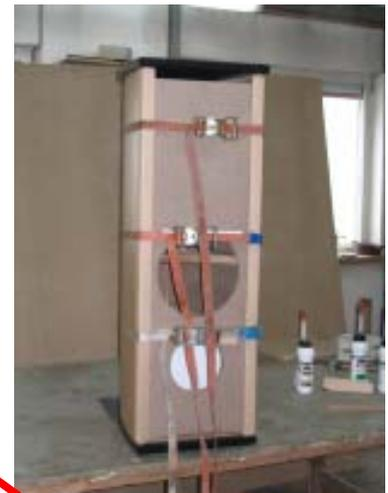
Bild mit Unterlegeklötzchen am Spanner
