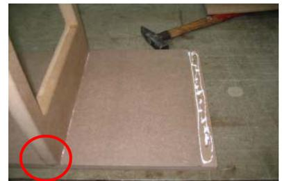
Weiter geht es mit der inneren Rückwand, hier müssen Sie gleich auf alle Spanten Leim angeben, Rückwand auflegen und dann **besonders auf den absolut gleichen seitlichen Überstand links und rechts achten**; das ist eine Schlüsselstelle beim Aufbau der Oval I, da die **Rückwand nicht gleichbreit mit den Spanten ist**; Liest sich schlimmer wie es ist;
